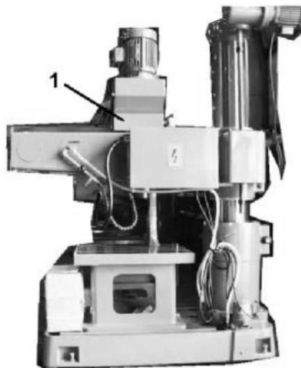
а. Снимите боковую пластину (см. Рис., № 1).
