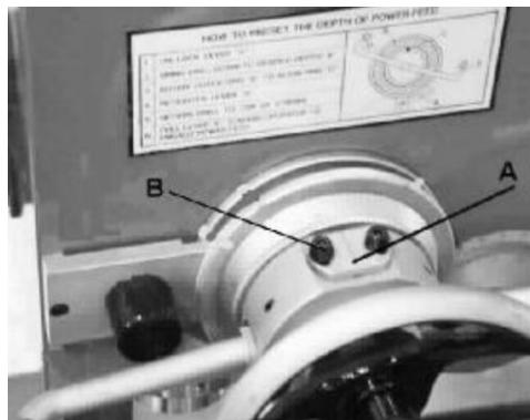
Ослабьте болты В, как показано на рисунке. При помощи шестигранного ключа переместите регулировочный блок вперёд. Затяните болты В, как показано на рисунке.
