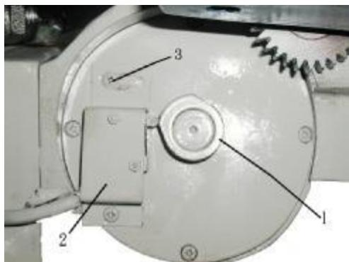
На рисунке показана шкала шпинделя. Вращайте шпиндель до максимального верхнего положения. Оставьте зазор от 3 до 5 мм. Смотрите фото 2. Вращайте эксцентрик 1, пока он не коснется концевого выключателя 2. Вращайте шпиндель до минимального нижнего положения. Оставьте зазор от 3 до 5 мм. Затяните эксцентрик и винт 3. Медленно вращайте эксцентрик, чтобы он коснулся концевого выключателя. После щелчка затяните винт.
