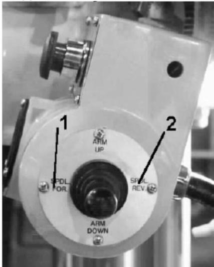
1. Включите главный выключатель, опустите пиноль на 5 мм так, чтобы можно было запустить функцию главного шпинделя «forward/reverse» – по часовой стрелке/против часовой стрелки.
