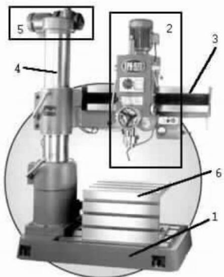
**1 Основание:** опора станка. В основании станка находится СОЖ, на основании установлен стол коробчатого сечения.
