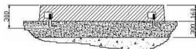
Эти схемы предназначены для основания и анкерных болтов, и для соответствующего положения станка JRD-920A.
