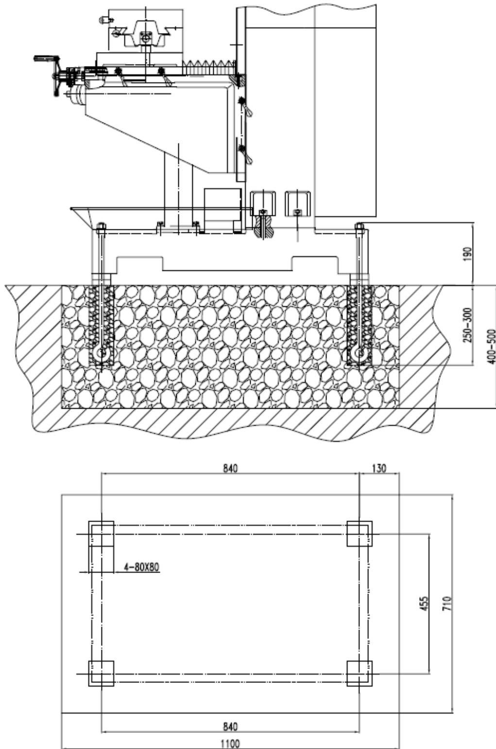
Отрегулируйте уровень станка таким образом, чтобы допуск неплоскости не превышал 0,04 мм / 1000 мм в поперечном и горизонтальном направлении после крепления станка четырьмя фундаментными болтами. При необходимости, установите проставки.
