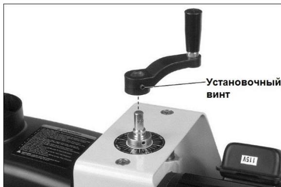
Рисунок 5-1: Установка ручки
