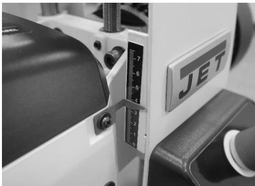
Рисунок 7-1: Регулировка шкалы высоты
