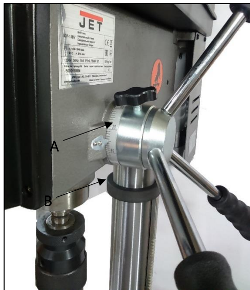
Рисунок 8-1. Регулировка ограничителя глубины сверления
