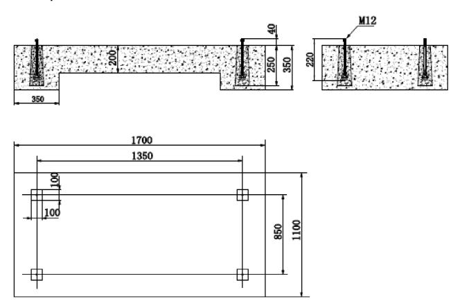
Установите станок на прочном цементном полу, соблюдая минимальное расстояние в 800 мм от стены в задней части. Закрепите его на земле, как показано на схеме, с помощью винтов и распорных втулок или стяжных стержней, утопленных в цемент, и убедитесь, что он стоит ровно. См. изображение выше.
