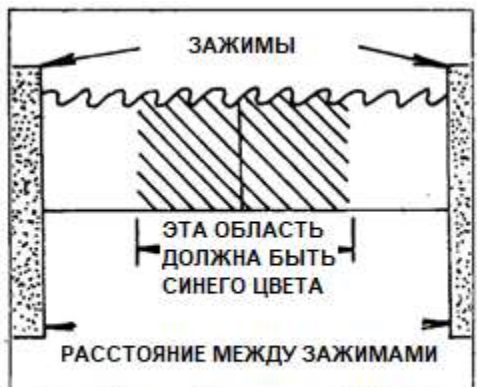
Правильные условия отжига полотна из углеродистой стали с жестким телом
