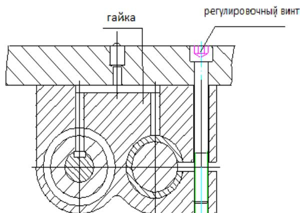
Рис. 7. Регулировка ходового винта резцедержателя
