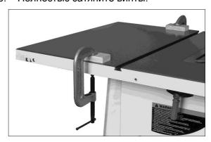
Рис. 5-6: выравнивание удлинений стола, способ 2
