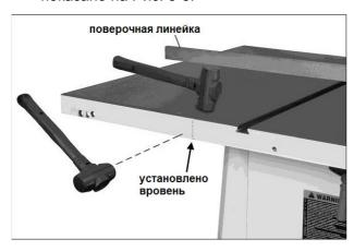
Рис. 5-5: выравнивание удлинений стола, способ 1
