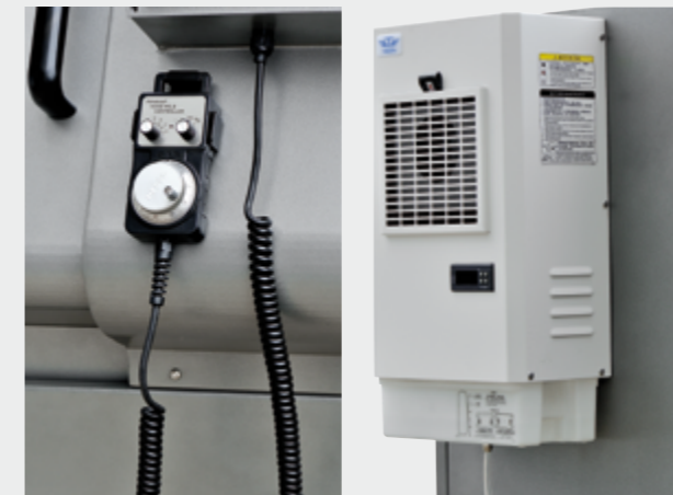
Магнитный маховик и кондиционер электрошкафа
