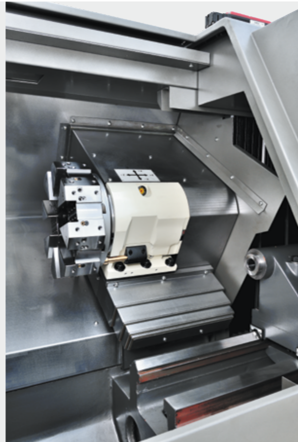
Ревolverная голова на 8 или 12 инструментов
