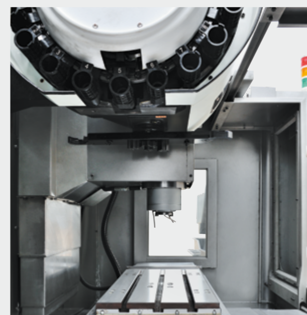
Инструментальный магазин до 30 позиций
