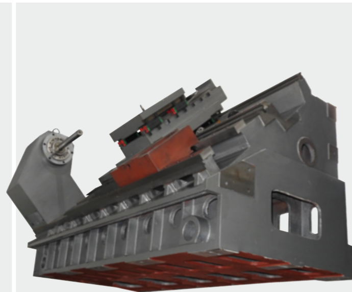
Цельнолитая станина JCL-30S CNC
