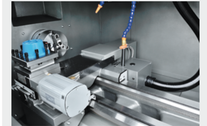
Направляющие закалены и отшлифованы
